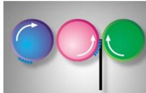
Blau: Plattenzylinder; Rosa: Gummizylinder; Grün: Gegendruckzylinder
